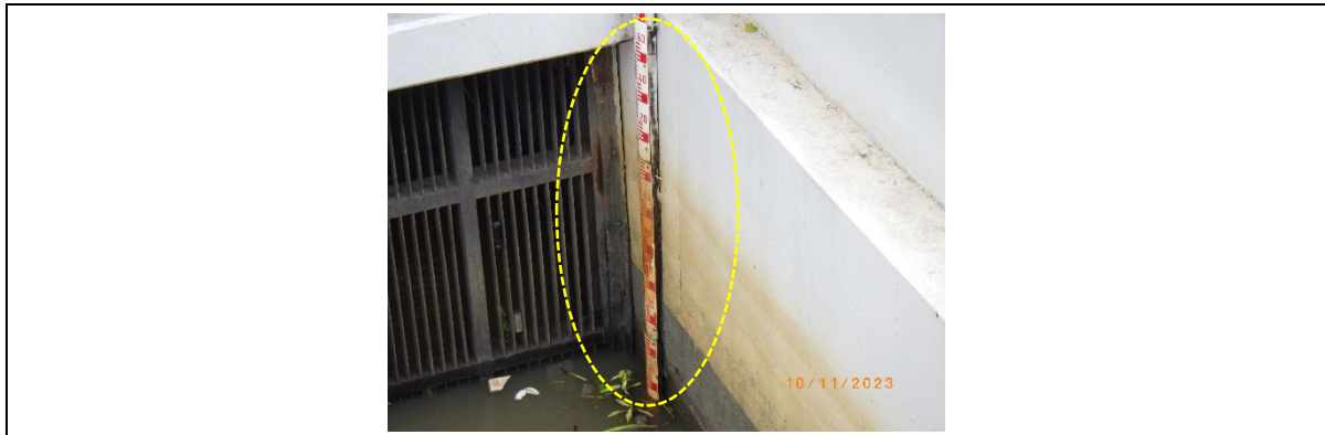
รูปที่ 2-6 การติดตั้งบรรทัดน้ำบริเวณแม่น้ำเจ้าพระยา
